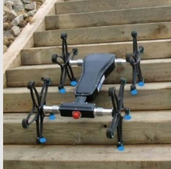
(Abb. 2) Durch wahrgenommenen Fußkontakt kann besser erkannt werden, wo sich Objekte befinden (hier: auf Treppenstufen)
