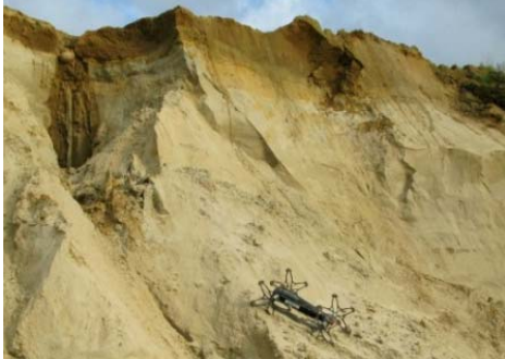
(Abb. 1) Der ASGUARD Roboter klettert in einer Sandgrube mit 40° Gefälle (sehr loser Untergrund)
