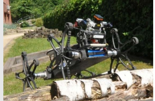
(Abb. 3) Der ASGUARD v3 kann durch Sensoren und on-board Datenverarbeitung auch unwegsames Gelände autonom überqueren
