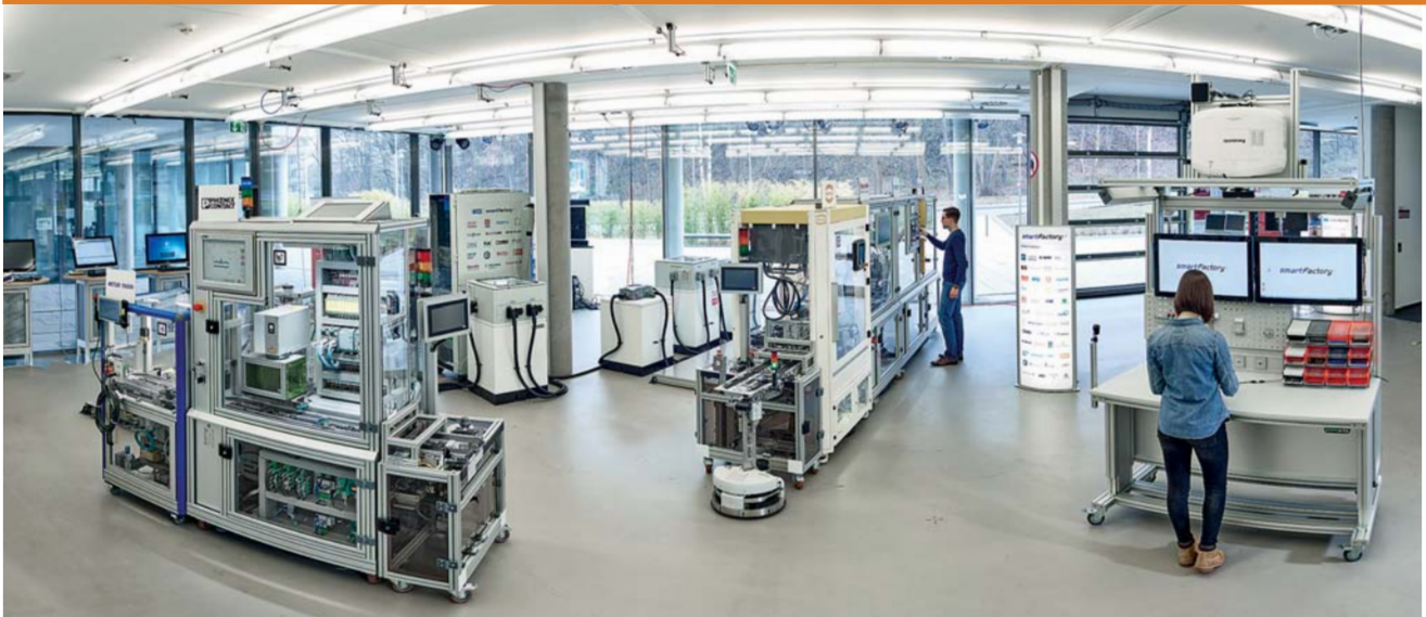
Die Module der Demo-Anlage des SmartFactory KL -Partnerkreises verteilen sich auf drei Fertigungsinseln, um eine flexible Produktion zu ermöglichen. Foto: SmartFactory KL / C. Arnoldi
