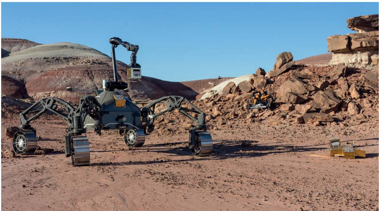
Der etwa 150 kg schwere SherpaTT eignet sich dank seines aktiven Fahrwerks besonders gut für unwegsames Gelände.
