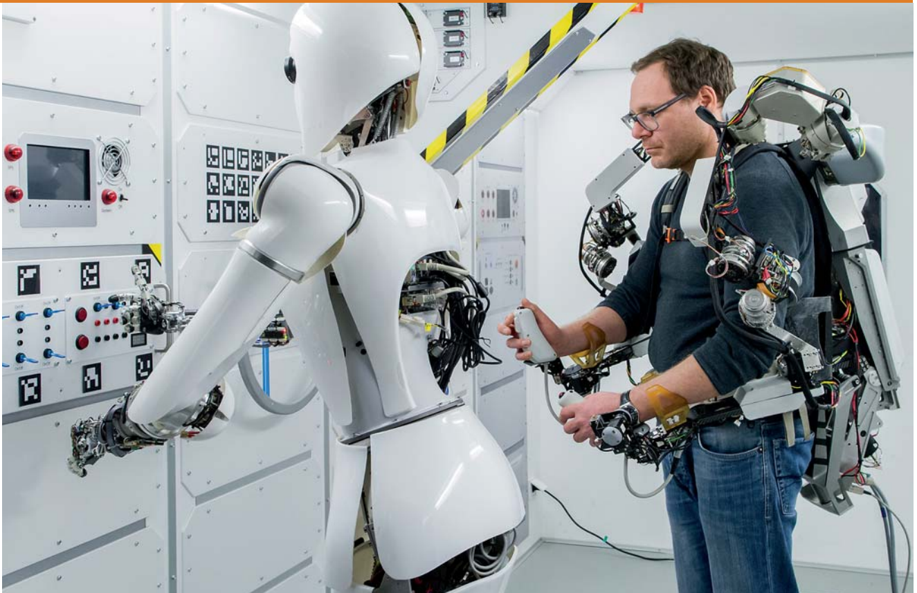
Das Exoskelett überträgt die Bewegungen seines Trägers direkt auf den Roboter.
