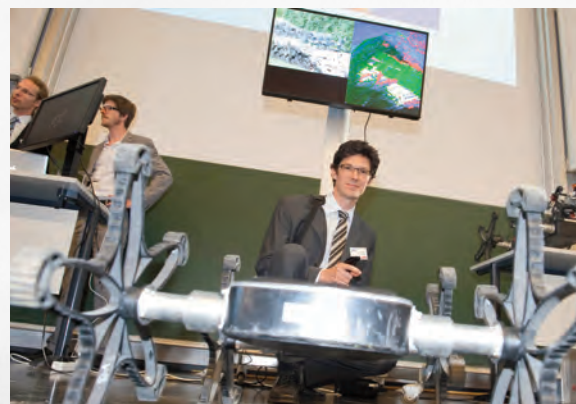
ASGUARD V2: Roboter für Sicherheitseinsätze im Außenbereich
