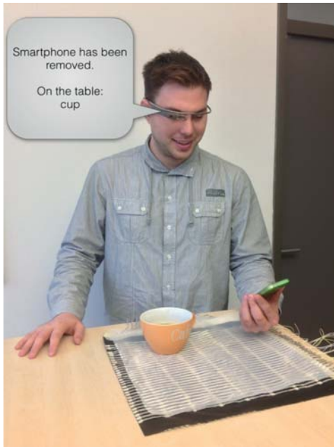
Gewebe mit integrierten Sensoren erkennt Objekte anhand ihrer Form und ihres Gewichts.
