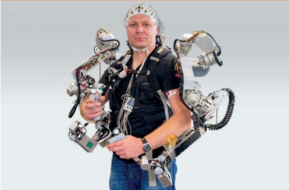
Das im Vorläuferprojekt Capio zur Fernsteuerung von robotischen Systemen realisierte Oberkörper-Exoskelett wird in RECUPERAREha für den Einsatz in der Rehabilitation weiterentwickelt.
